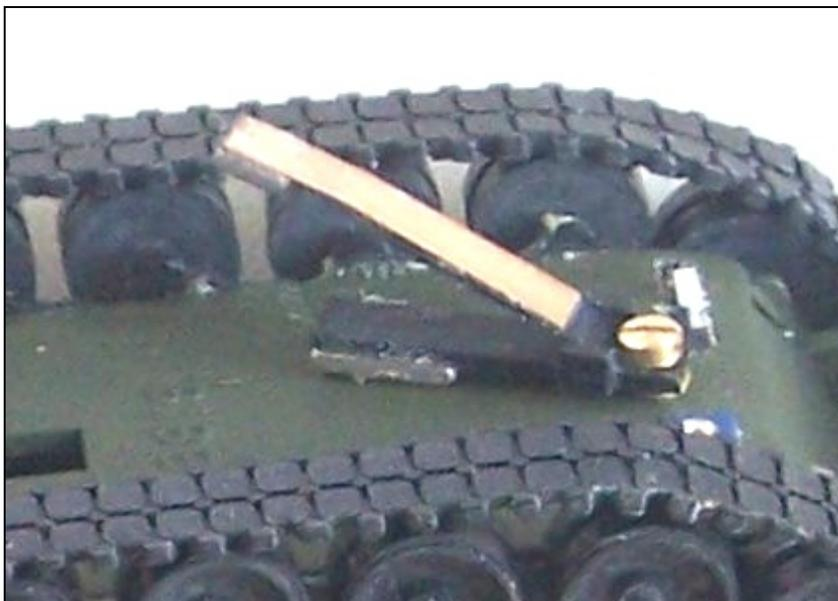
Als Schaltmagnet wird ein 6x3x1mm Magnet längs auf den Schalthebel des Lenkstü-ckes aufgeklebt. Dadurch wird die Magnetkraft soweit verstärkt, daß auch die Reedkontakte der 2. Lenkstellung umschalten und das Fahrzeug auf der Stelle dreht.
