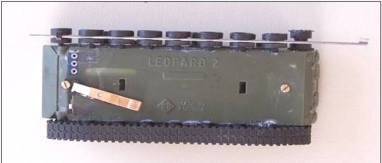
Abb. 51: Das Laufwerk so ausrichten, dass die Endstellung der Laufräder eine Linie ergibt.
