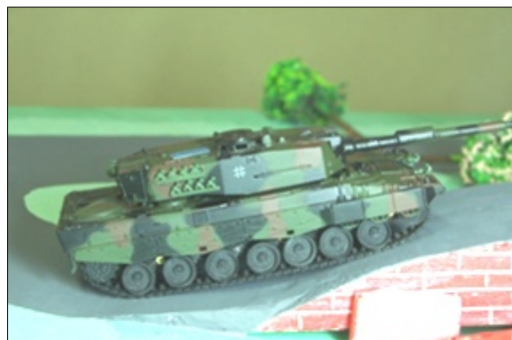
Abb. 4: Kette hängt an der Steigung frei.
