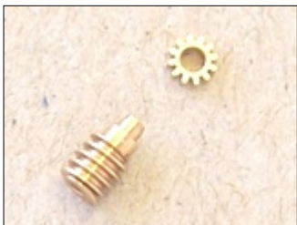
Abb. 22: Ritzel mit sehr wenig Kleber aufdrücken.
