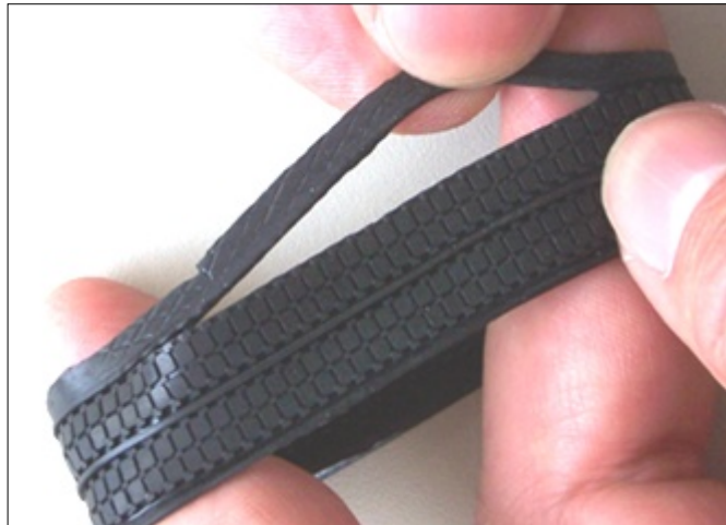
Abb. 53: Zwischenabfallsteg ebenfalls entfernen
