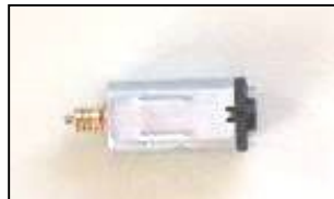
Abb. 12 und 13: Bei der Montage der Schnecke das Lagerschild fixieren. Schnecke bis zur Motorwand (Lagerschild) aufdrücken.
