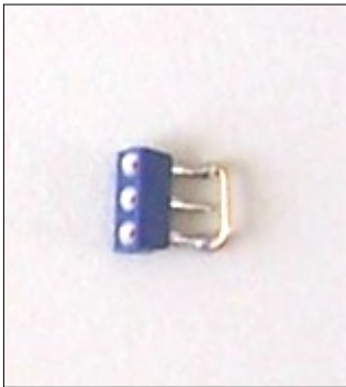
Abb. 10: Brücke in Ladesteckdose 3-polig setzen
