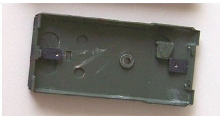
Abb. 32: Verschraubung ausgemittelt Kleber bündig einkleben
